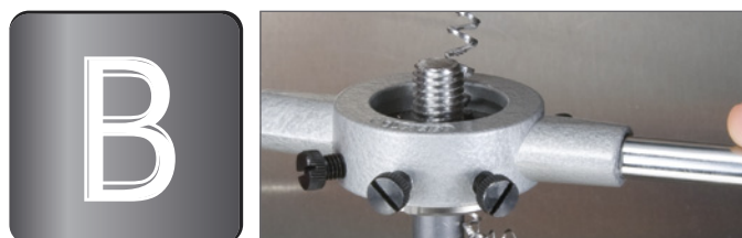
Форма В плашки = закрытое исполнение с предварительным шлицеванием!
